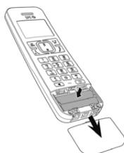
Instale as baterias no compartimento situado na parte frontal do telefone. Para isso, abra o compartimento das baterias (12) mediante ligeira pressão e deslize a tampa até baixo. Conecte o pack de baterias ao conector interior do próprio compartimento. Só é possível fazê-lo numa das posições. Assegure-se que coloca as baterias na posição correcta. Só é possível fazê-lo numa das posições. Volte a colocar a tampa.
