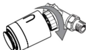
Pressione o botão do controlo rotativo da válvula brevemente, o display irá começar a piscar novamente apresentando a mensagem "LA" no display enquanto realiza o ajuste automático.
