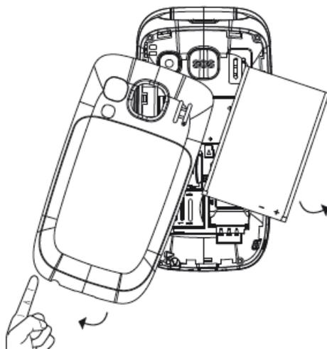
Levanta la tapa de la batería empleando la pestaña situada en la parte inferior del teléfono.
