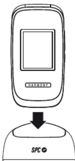
Para cargar el terminal, conecta el alimentador a la base cargadora y a cualquier enchufe de tu hogar. Comprueba la orientación del conector y no fuerces la conexión si esta no es inmediata. Coloca el teléfono sobre la base cargadora.
