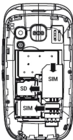
Introduce la(s) tarjeta(s) SIM haciendo coincidir los contactos dorados del teléfono y la(s) tarjeta(s).
