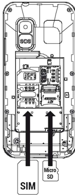
Introduce la tarjeta SIM (formato MiniSIM) desde arriba en la posición indicada, haciendo coincidir los contactos metálicos del teléfono y la tarjeta. Si deseas añadir una tarjeta de memoria Micro SD, hazlo levantando la pestaña de su bandeja e introduciendo la tarjeta según se indica en la figura.
