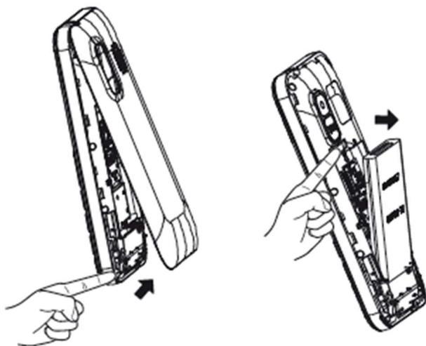
Levanta la tapa de la batería y la batería, empleando la pestaña situada en la parte inferior del teléfono y la pestaña de la parte superior del compartimento de la batería.
