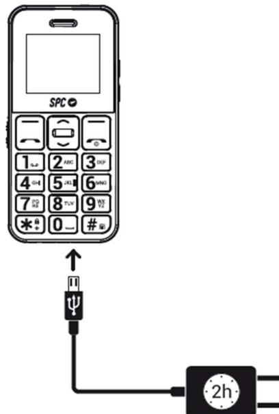
Para cargar el terminal, conecta el alimentador al conector micro USB del teléfono situado en la parte inferior del mismo. Comprueba la orientación del conector y no fuerces la conexión si esta no es inmediata.
