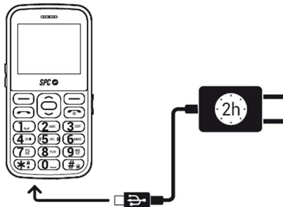
1.- Conecta el adaptador que encontrarás en la caja en cualquier enchufe de tu hogar. Conecta el otro extremo del alimentador al conector del teléfono para carga de batería.
