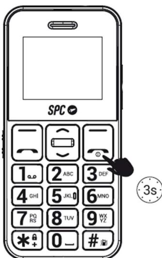
Mantén pulsada la tecla de encendido ON/OFF durante unos segundos para encender el teléfono. Introduce el PIN que aparece en tu tarjeta SIM.
