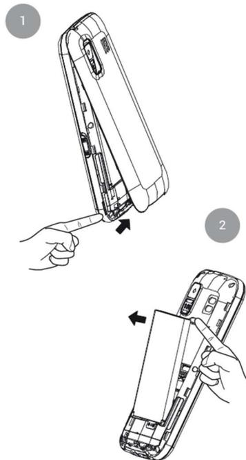
Sollevare il copribatteria usando la linguetta nella parte inferiore del telefono, ed estrarre la batteria sollevandola dall'incisione nella parte superiore del vano batteria.
