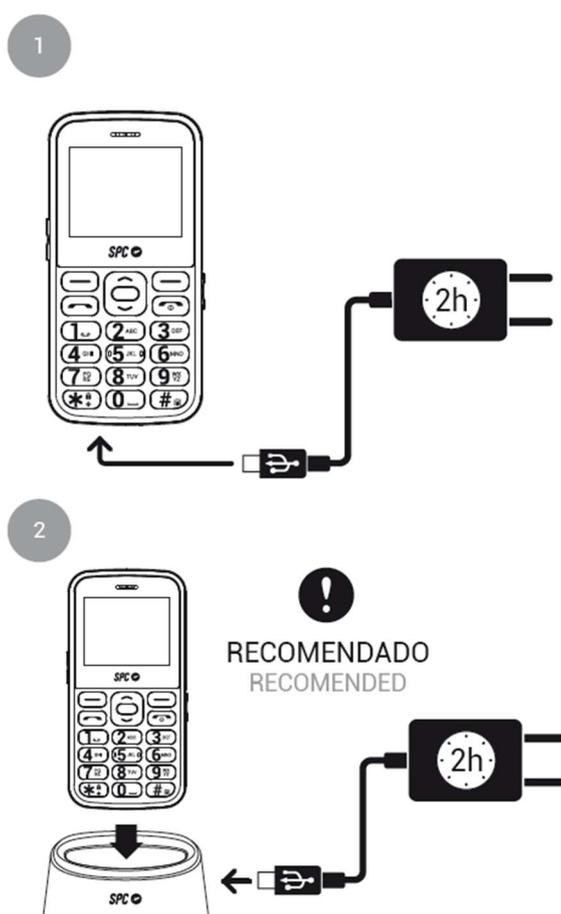
1.- Collegare l'alimentatore fornito nella scatola a qualunque presa a muro di casa. Collegare l'altro capo dell'alimentatore alla porta del telefono per caricare la batteria.
