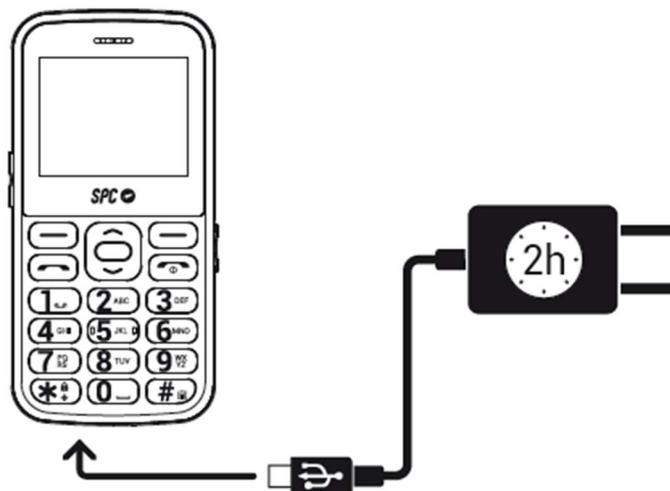
Per caricare il telefono, collegare l'alimentatore alla porta USB di alimentazione nella parte inferiore del telefono. Il connettore USB è di tipo C, per cui non bisogna seguire uno specifico verso. Non forzare l'aggancio se non dovesse risultare immediato.
