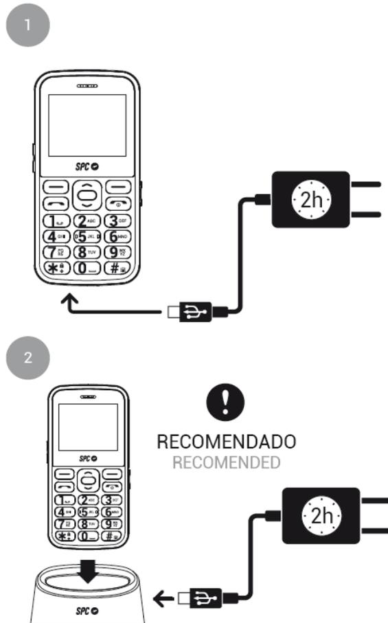
1.- Branchez l'adaptateur que vous trouverez dans la boîte sur n'importe quelle prise de courant de votre maison. Connectez l'autre extrémité du bloc d'alimentation au connecteur du téléphone pour charger la batterie.
