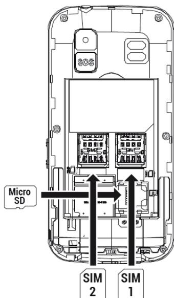
Insérez la ou les cartes SIM (format MicroSIM) dans la position indiquée, en faisant correspondre les contacts dorés du téléphone et de la ou des cartes.
