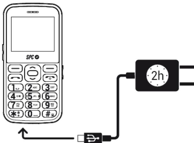
Pour charger le téléphone, connectez le bloc d'alimentation au connecteur USB du téléphone, situé sous le téléphone. Le chargeur est un câble USB Type-C, ce qui signifie qu'il n'a pas d'orientation spécifique. Toutefois, ne forcez pas la connexion en cas de difficulté de connexion immédiate.
