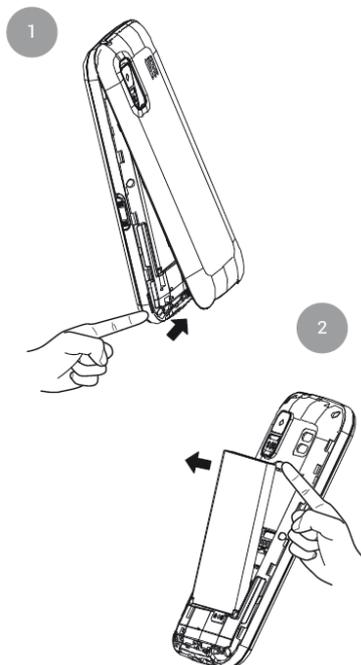
Soulevez le couvercle de la batterie en utilisant la languette située au bas du téléphone, et la batterie en la soulevant par l'encoche située en haut du compartiment de la batterie.
